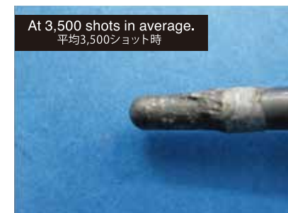
At 3,500 shots in average. 平均3,500ショット時 Conventional sample 従来品
