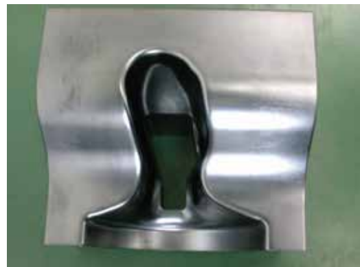
Application of FSP+Polish+Ti coating to press dies. プレス型への処理適用FSP+OX-Polish+Tiコート
