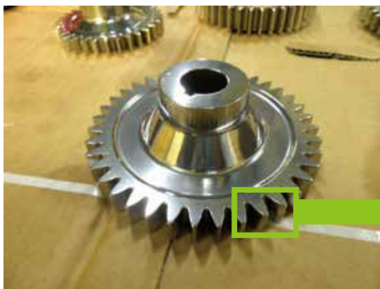
Cam gear for diesel engine. エンジン用カムGEAR
