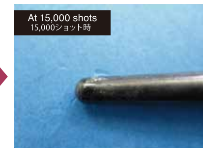
At 15,000 shots 15,000ショット時 OXISO-processed samples OXISO処理品
